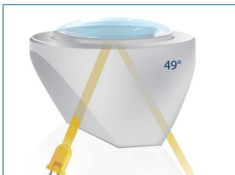
Para una muestra de agua sobre un prisma de zafiro, el ángulo crítico de reflexión total es de 49°.
