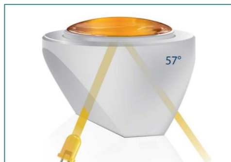
Para una muestra con miel (contenido de agua del 18%), el ángulo crítico de reflexión interna total es de 57°.
