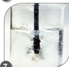
La sonda de agitador permite que las muestras se mezclen de manera uniforme, ayuda a evitar que los electrodos sufran daños y es fácil de enjuagar entre muestras.
