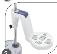
El soporte de electrodos proporciona un movimiento seguro y suave del electrodo durante el proceso de medición.
