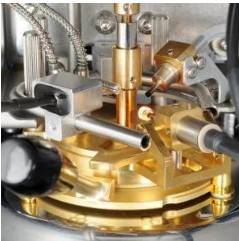
PM-93 Medidor del punto de inflamación Pensky-Martens
